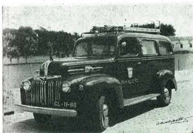
Coche marca Ford de primera salida, para seis bomberos. Lleva una moto-bomba portátil alemana, extintores, escalas, mangueras y diverso material
